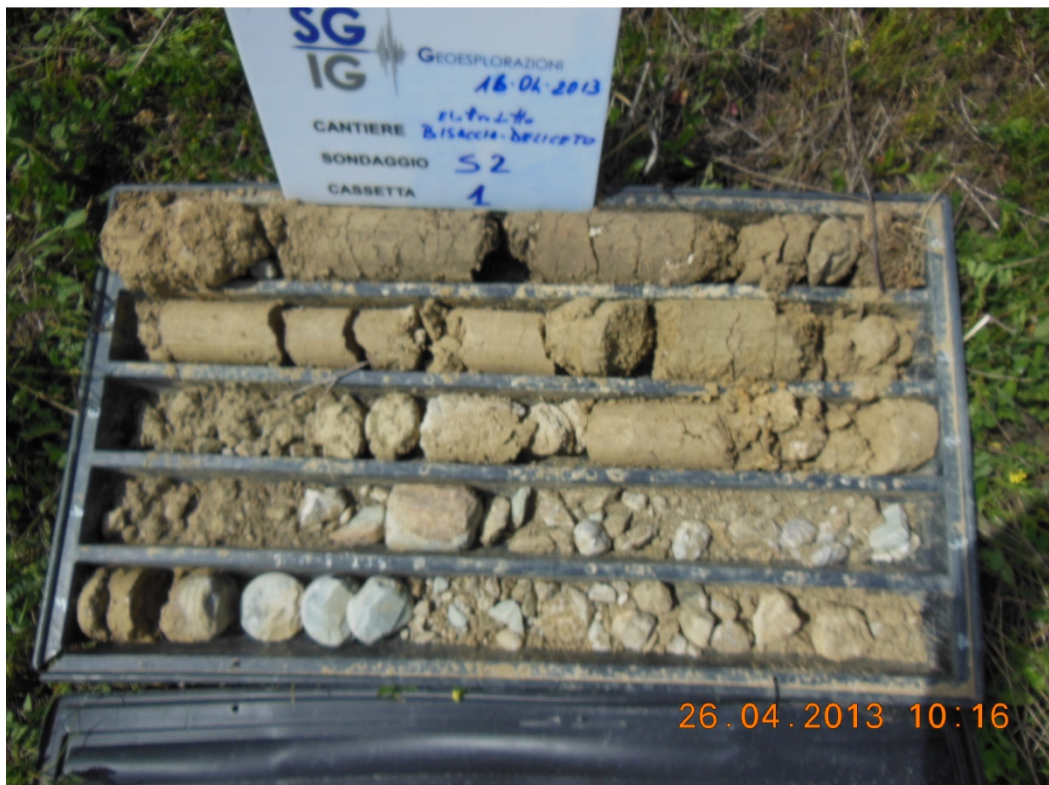
Foto 4:cassetta con carote da 0.00 m a 5.00 m
