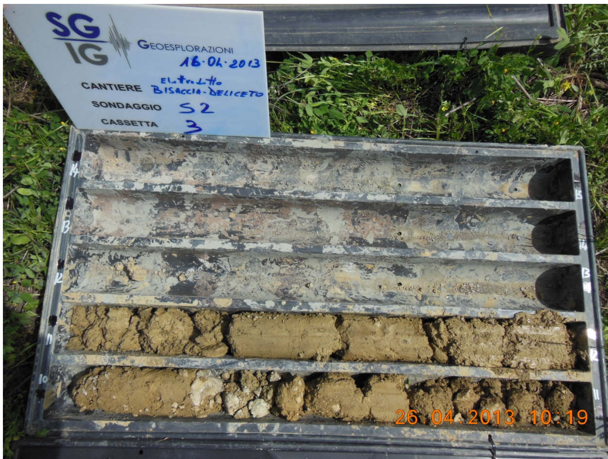
Foto 7:cassetta con carote da 10.00 m a 15.00 m
