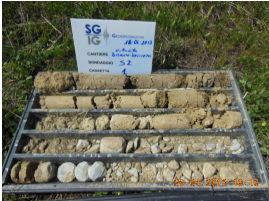
Foto 3:cassetta con carote da 0.00 m a 5.00 m
