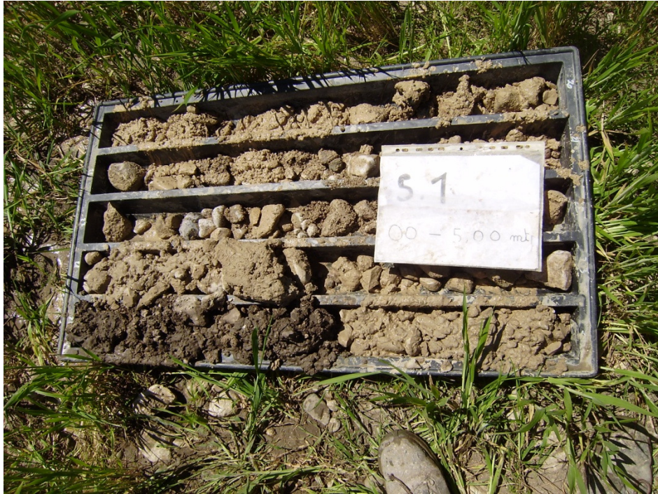
Foto 3:cassetta con carote da 0.00 m a 5.00 m
