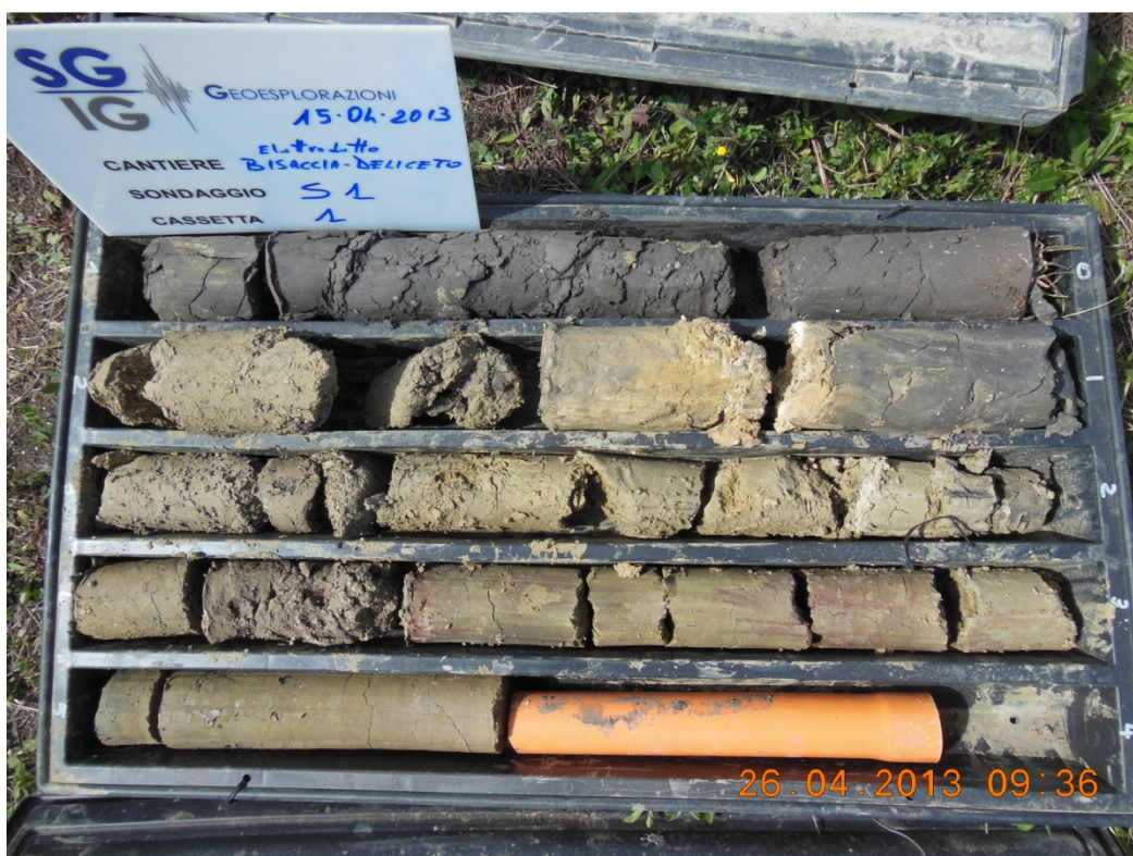
Foto 4:cassetta con carote da 0.00 m a 5.00 m
