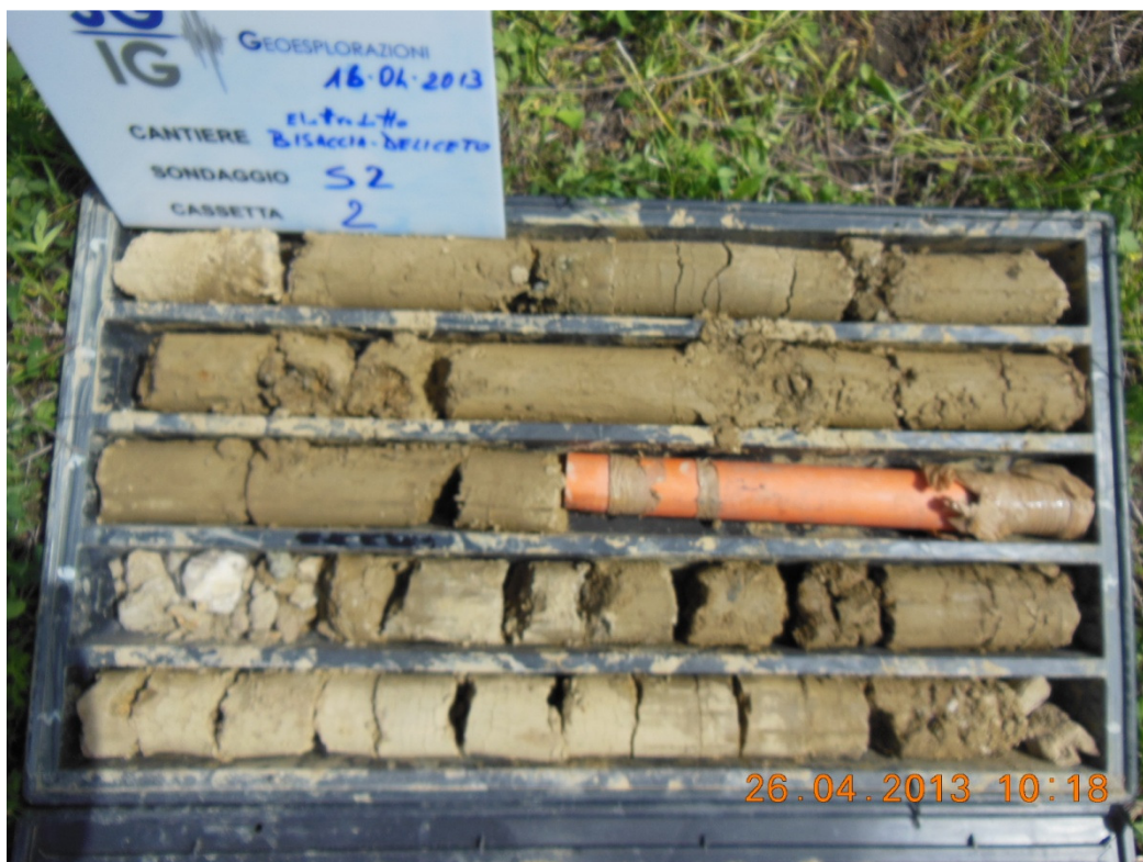
Foto 6:cassetta con carote da 5.00 m a 10.00 m
