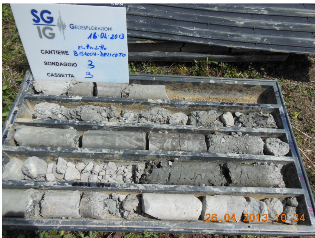
Foto 6:cassetta con carote da 10.00 m a 15.00 m
