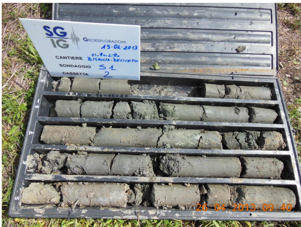
Foto 5:cassetta con carote da 5.00 m a 10.00 m
