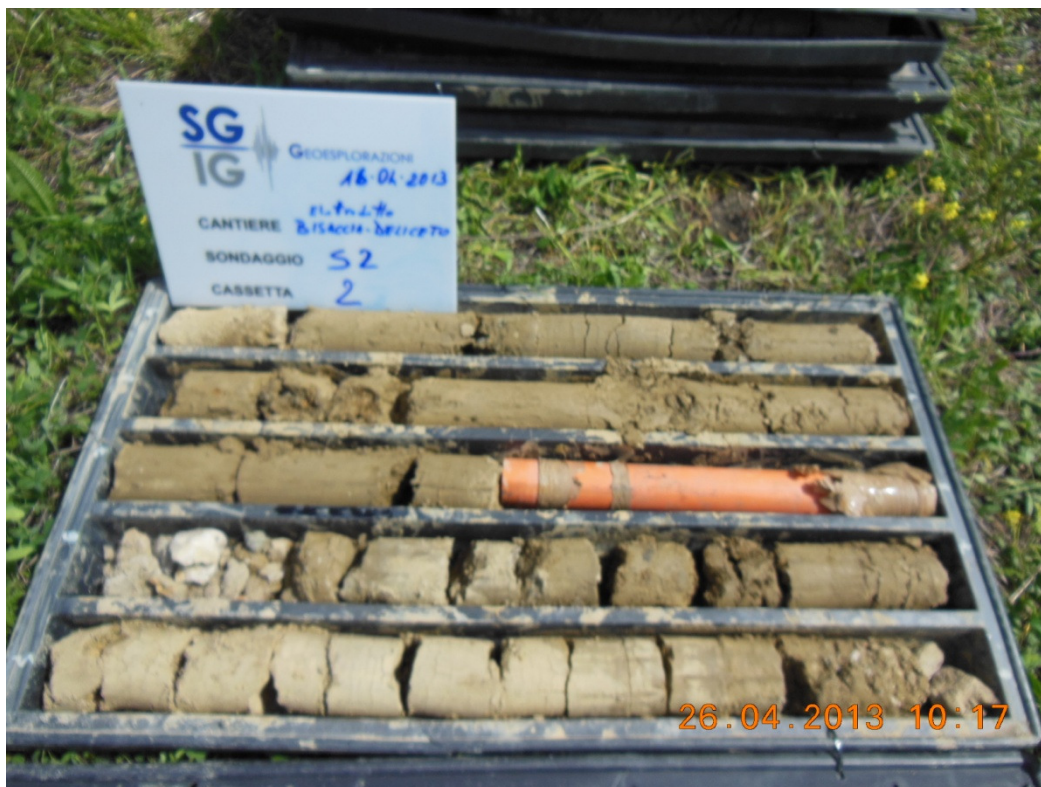
Foto 5:cassetta con carote da 5.00 m a 10.00 m
