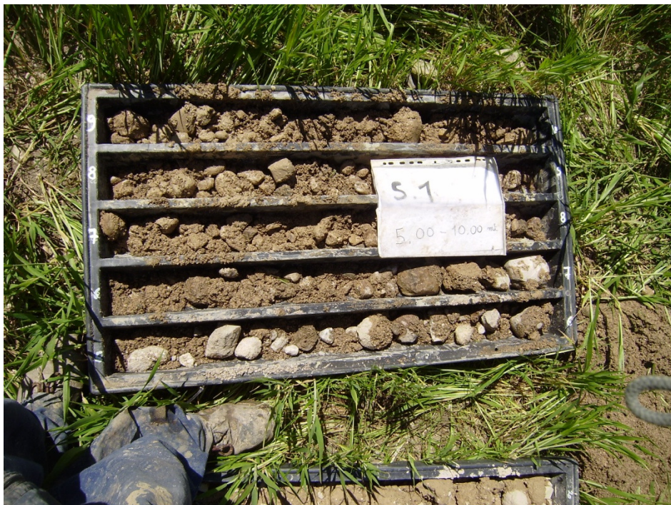
Foto 4:cassetta con carote da 5.00 m a 10.00 m
