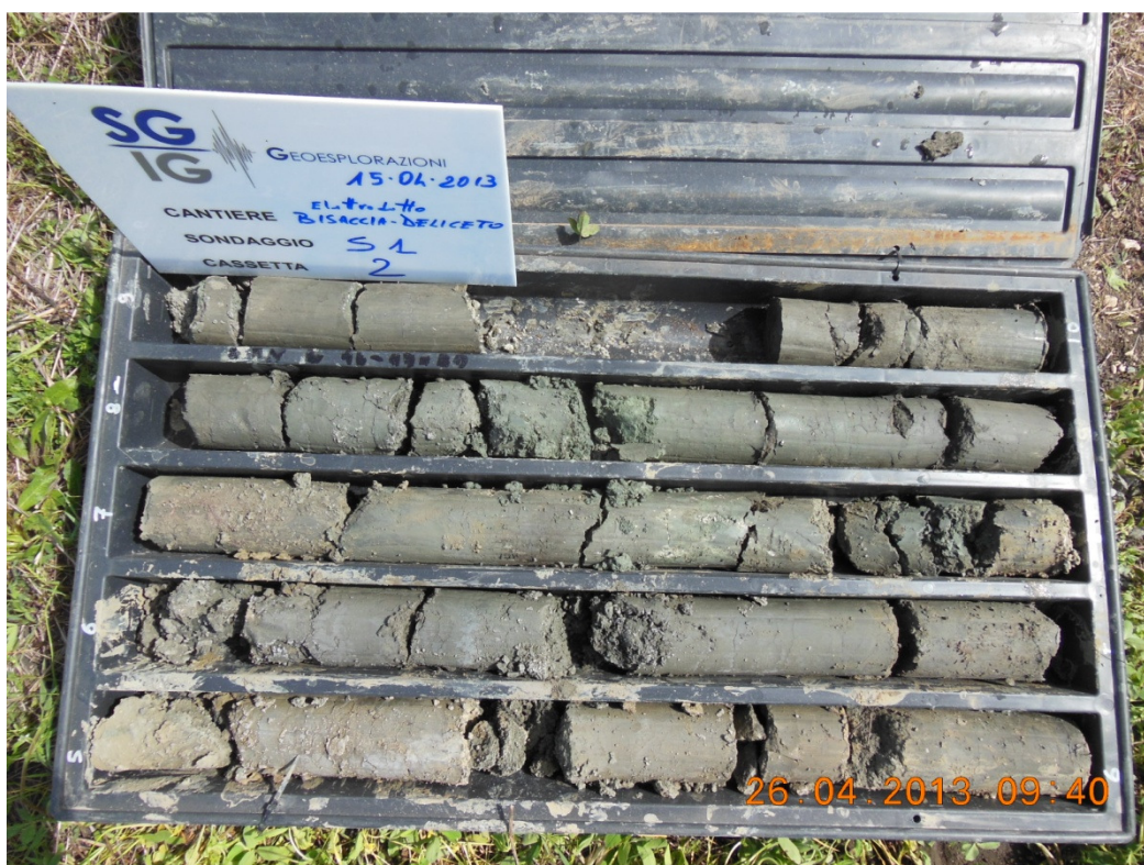
Foto 6:cassetta con carote da 5.00 m a 10.00 m
