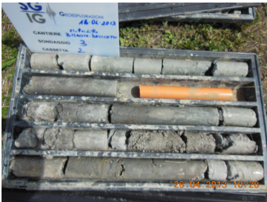
Foto 5:cassetta con carote da 5.00 m a 10.00 m
