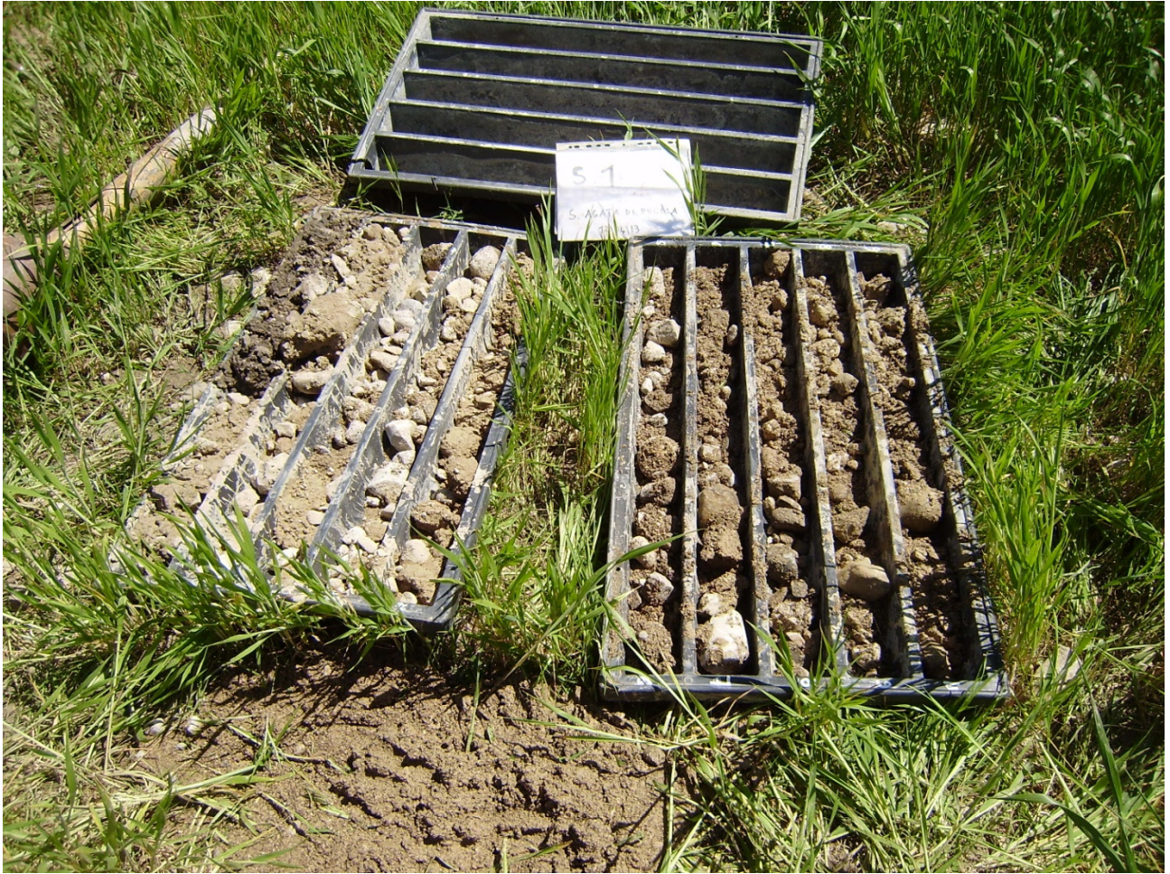
Foto 5:cassetta con carote da 0.00 m a 10.00 m
