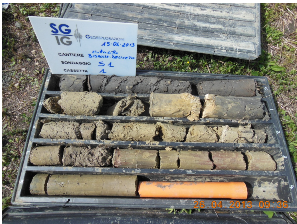
Foto 3:cassetta con carote da 0.00 m a 5.00 m
