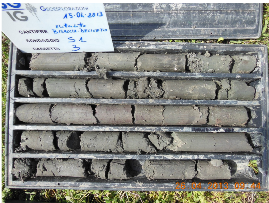
Foto 8: cassetta con carote da 10.00 m a 15.00 m
