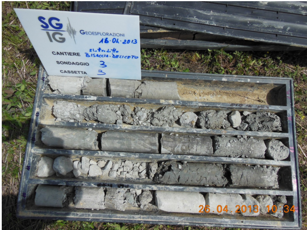
Foto 7:cassetta con carote da 10.00 m a 15.00 m
