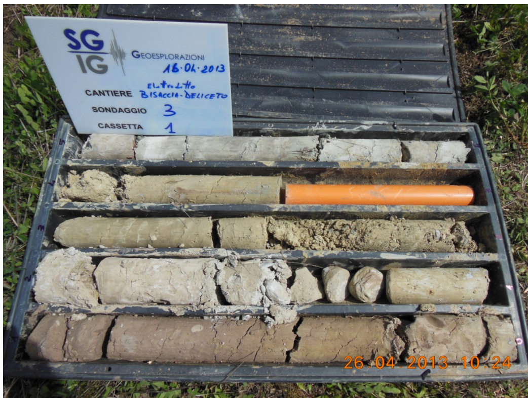
Foto 3:cassetta con carote da 0.00 m a 5.00 m
