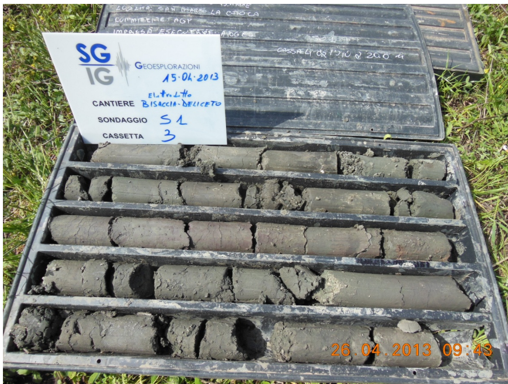
Foto 7: cassetta con carote da 10.00 m a 15.00 m
