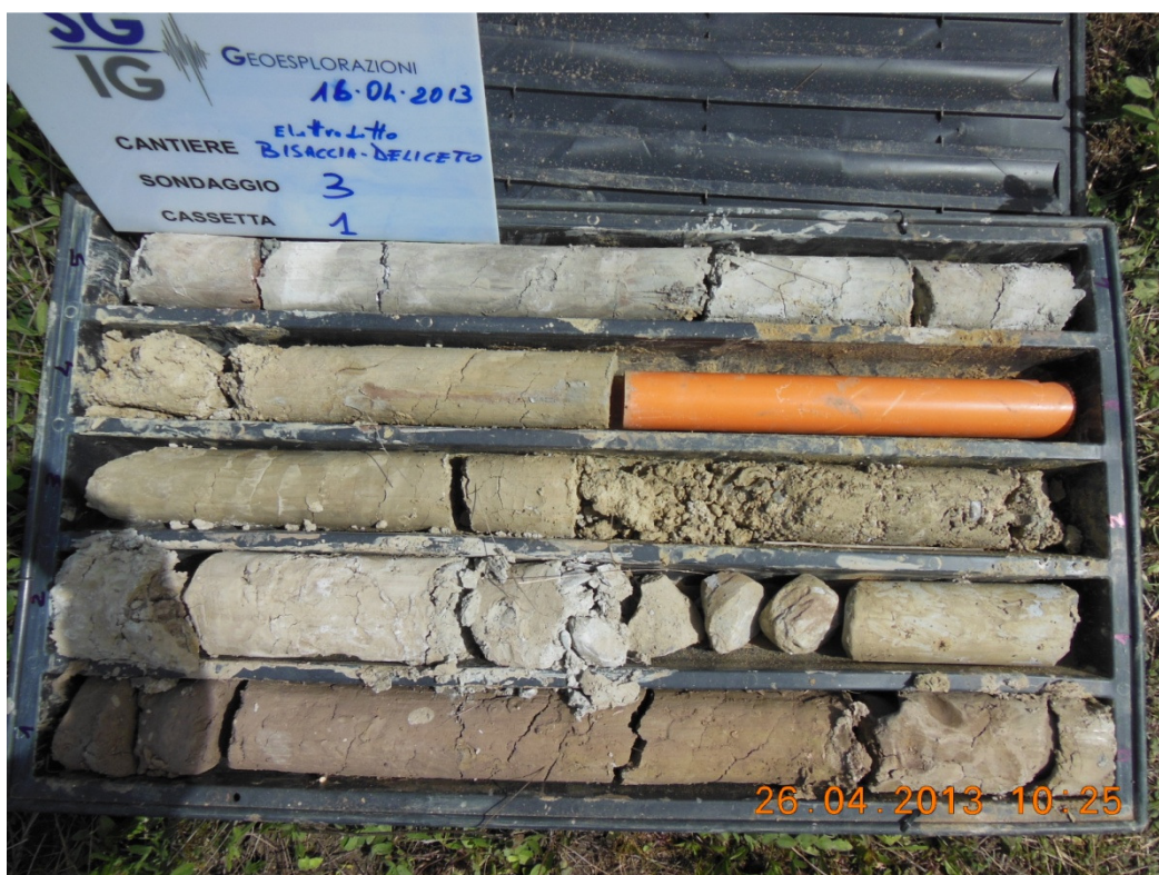
Foto 4:cassetta con carote da 0.00 m a 5.00 m
