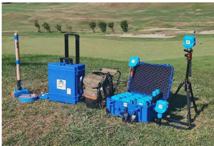
Figura 1. Strumentazione MASW della Donlang Geophysical
