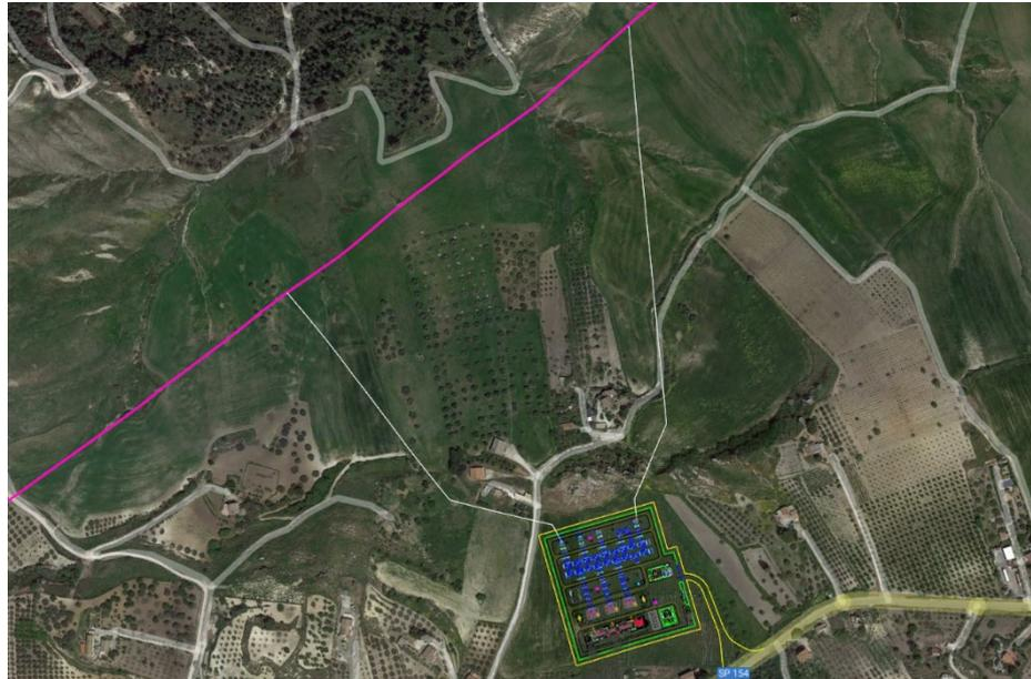
Figura 3-17: Raccordi alla linea 150 kV per il sito di cui all'ipotesi B
