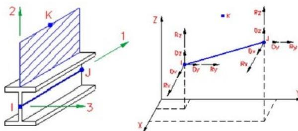
Il modello di calcolo realizzato risulta il seguente. Il tracker è stato modellato con vincolo di incastro al piede.
