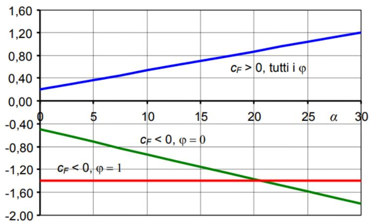
Per il calcolo della forza dovuta al vento si considerano le condizioni di carico più gravose tra le quattro indicate nella seguente figura, dove la forza risultante  $F_v = q_p(z) \cdot L^2 \cdot c_f(\alpha)$  è applicata sopravento ad una distanza pari a  $d / 4$  dal bordo investito dal flusso, dove  $d$  è la luce dell'elemento investito dal vento.
