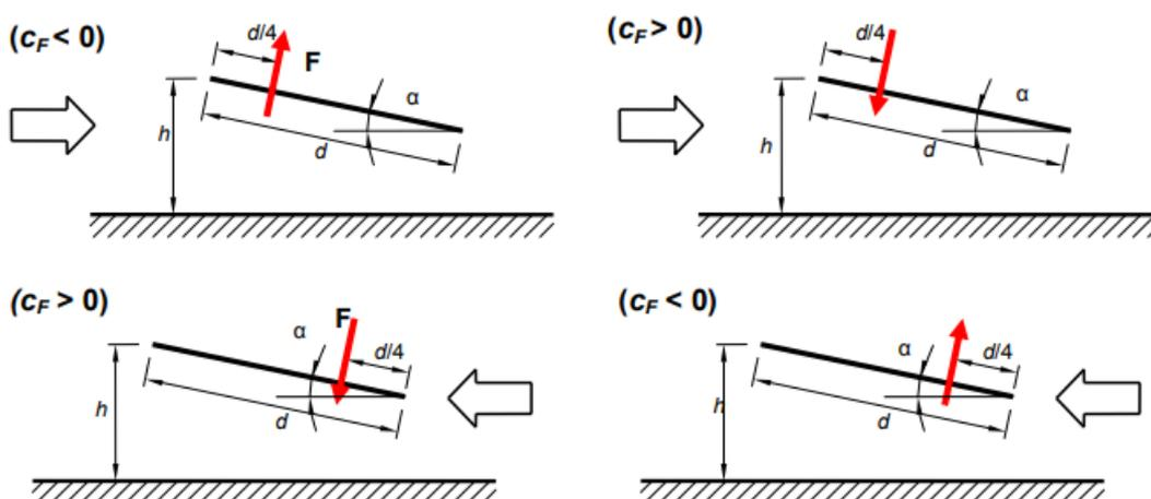
Di seguito si evidenziano i valori di  $c_f$  al variare dell'inclinazione  $\alpha$  dei pannelli fotovoltaici, sia in caso di pannello sopravento ( $c_f$  positivi) sia in caso di pannello sottovento ( $c_f$  negativi).
