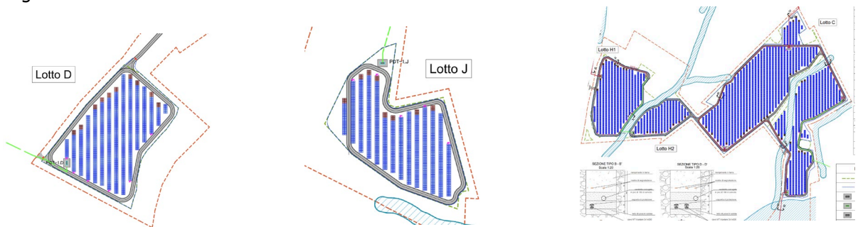
Schema planimetrico reale dei lotti D, J, C ed H con linea di recinzione, fascia di mitigazione e cabina elettrica schema tipologico utilizzato per tutti i lotti
