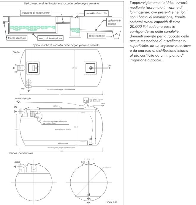
L'approvvigionamento idrico avverrà mediante l'accumulo in vasche di laminazione, ove presenti e nei lotti con i bacini di laminazione, tramite serbatoi aventi capacità di circa 20.000 litri cadauno posti in corrispondenza delle canalette drenanti previste per la raccolta delle acque meteoriche di ruscellamento superficiale, da un impianto autocevole e da una rete di distribuzione interna al sito costituita da un impianto di irrigazione a goccia.
