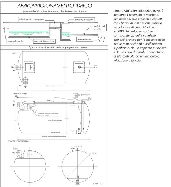
L'approvvigionamento idrico avverrà mediante l'accumulo in vasche di laminazione, ove presenti e nei lotti con i bacini di laminazione, tramite serbatoi aventi capacità di circa 20.000 litri caduno posti in corrispondenza delle canalette drenanti previste per la raccolta delle acque meteoriche di ruscellamento superficiale, da un impianto autoclave e da una rete di distribuzione interna al sito costituito da un impianto di irrigazione a goccia.
