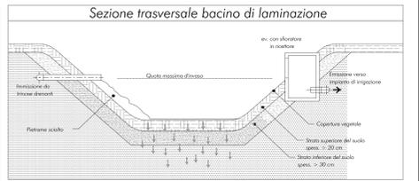
Le vasche e i bacini di laminazione sono serbatoi di stoccaggio temporaneo delle acque meteoriche di ruscellamento piovane prodotte all'interno del sito d'installazione, raccolte e canalizzate dal sistema delle canalette drenanti.
