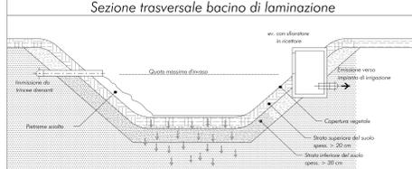
Le vasche e i bacini di laminazione sono serbatoi di stoccaggio temporaneo delle acque meteoriche di ruscellamento pioggia prodotte all'interno del sito d'installazione, raccolte e canalizzate dal sistema delle canalette drenanti.
