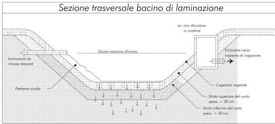
Le vasche e i bacini di laminazione sono serbatoi di stoccaggio temporaneo delle acque meteoriche di ruscellamento pioggia prodotte all'interno del sito d'installazione, raccolte e canalizzate dal sistema delle canalette drenanti.
