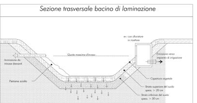
Le vasche e i bacini di laminazione sono serbatoi di stoccaggio temporaneo delle acque meteoriche di ruscellamento piovane prodotte all'interno del sito d'installazione, raccolte e canalizzate dal sistema delle canalotte drenanti.
