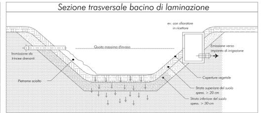
Le vasche e i bacini di laminazione sono serbatoi di stoccaggio temporaneo delle acque meteoriche di ruscellamento pioggia prodotte all'interno del sito d'installazione, raccolte e canalizzate dal sistema delle canalette drenanti.
