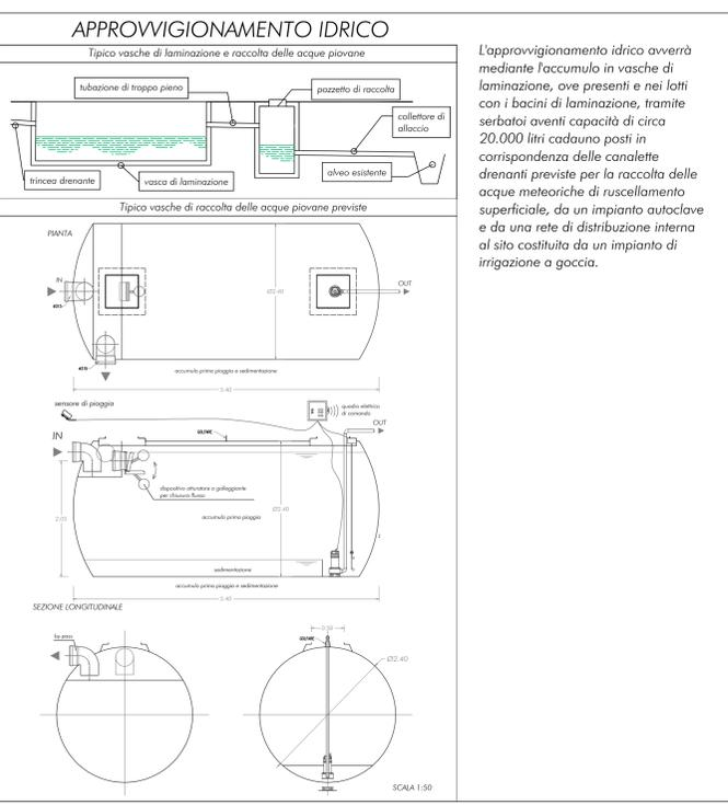
L'approvvigionamento idrico avverrà mediante l'accumulo in vasche di laminazione, ove presenti e nei lotti con i bacini di laminazione, tramite serbatoi aventi capacità di circa 20.000 litri cadauno posti in corrispondenza delle canalette drenanti previste per la raccolta delle acque meteoriche di ruscellamento superficiale, da un impianto autoclave e da una rete di distribuzione interna al sito costituita da un impianto di irrigazione a goccia.
