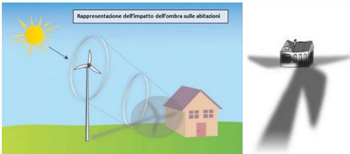
*Figura 22 - Esempio grafico del potenziale effetto di ombreggiamento di un aerogeneratore nei confronti di un edificio*
