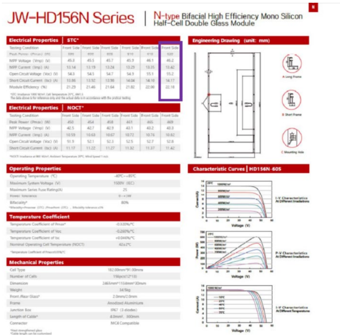
Figura 6.5. – Scheda tecnica del modulo fotovoltaico della JOLYWOOD, modello JW-HD156N BIFACIAL.
