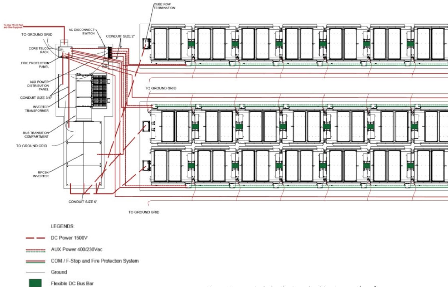
Figura 30: esempio di distribuzione di cablaggi per un "core"
