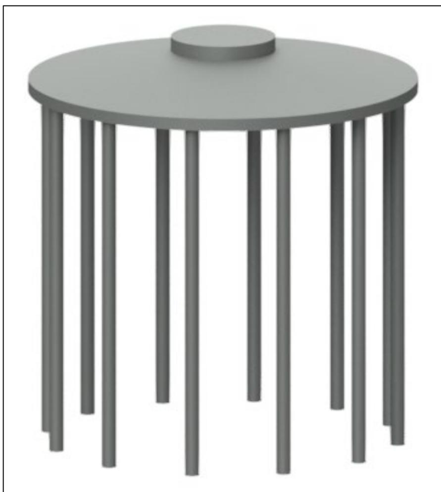
Figura 3: vista tridimensionale della fondazione dell'aerogeneratore
