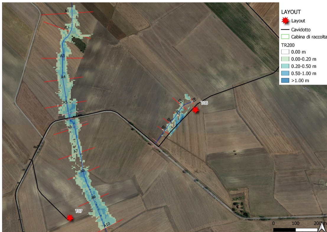
Figura 8: Delimitazione delle aree allagabili impluvi A e B con tempo di ritorno di 200 anni
