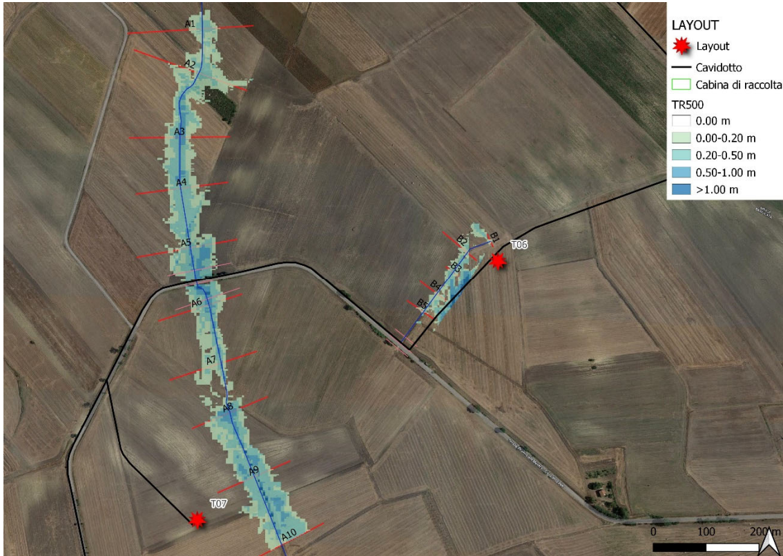
Figura 11: Delimitazione delle aree allagabili impluvi A e B con tempo di ritorno di 500 anni
