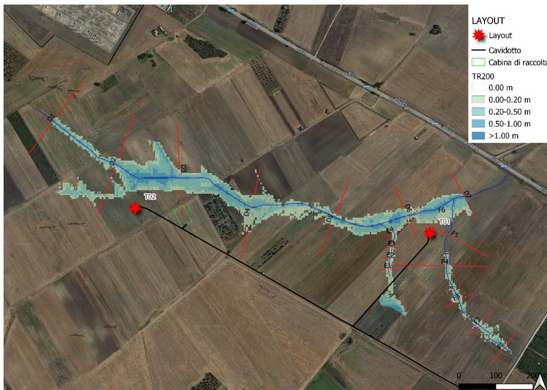
Figura 10: Delimitazione delle aree allagabili impluvi D,E ed F con tempo di ritorno di 200 anni
