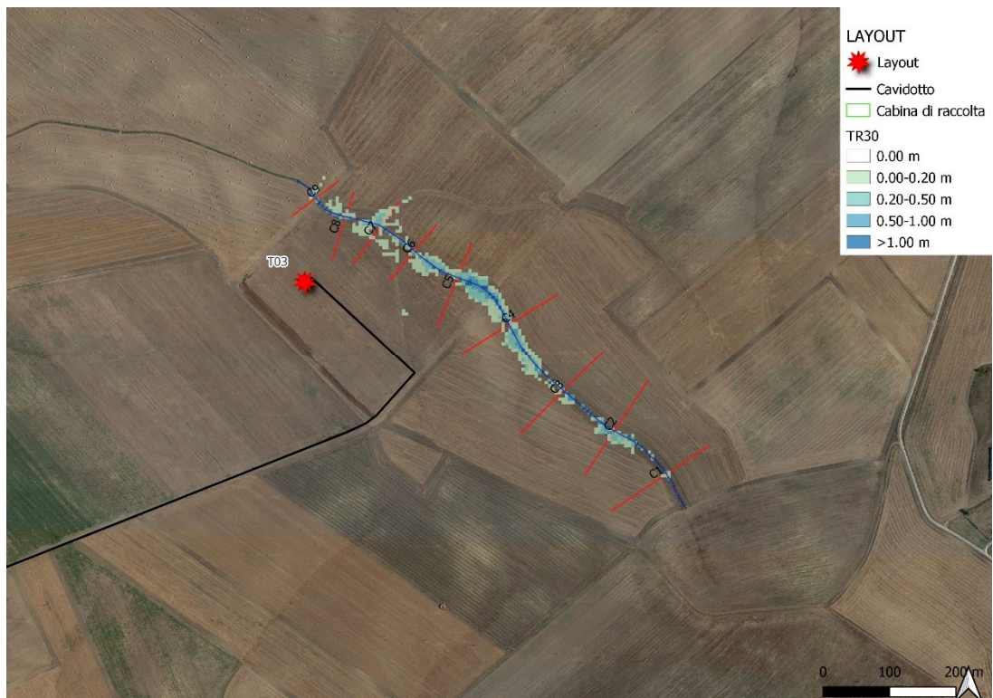
Figura 6: Delimitazione delle aree allagabili impluvio C con tempo di ritorno di 30 anni
