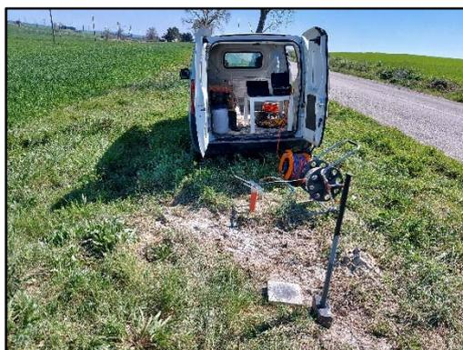
**Fotografia 6**-Postazione down-hole S2-DH in foro S2-DH
