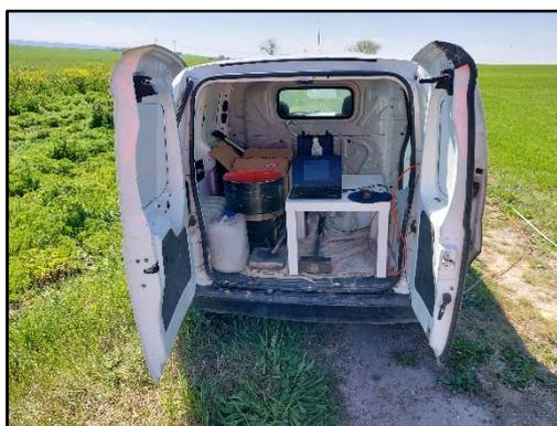
**Fotografia 5** - Sismografo PASI modello GEA24
