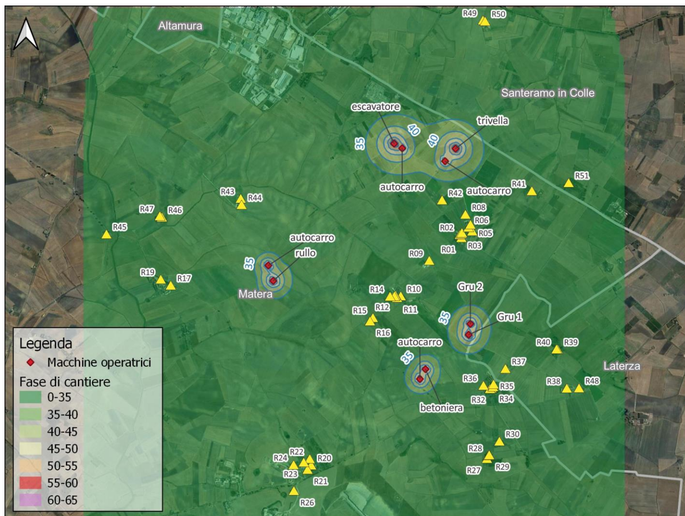
Figura 22. Stralcio della mappa d'impatto con indicazione delle isofoniche di emissione dovute alle macchine operatrici impiegate e relative al periodo diurno
