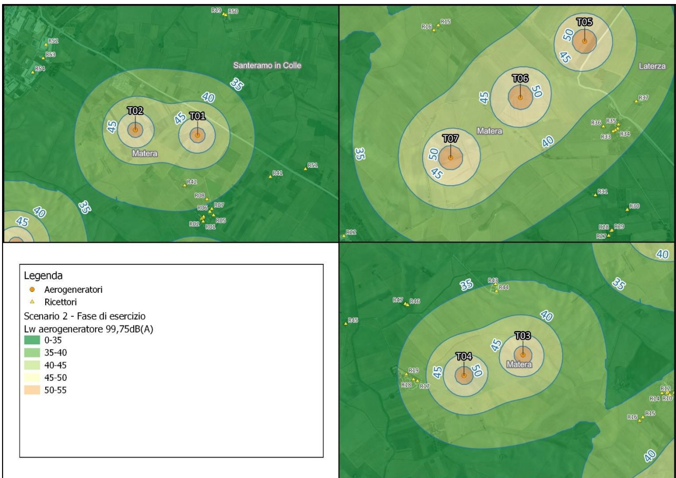
Figura 23: stralci della mappa previsionale del rumore emesso post operam; Ri: ricettori, T0i: aerogeneratori SCENARIO 2
