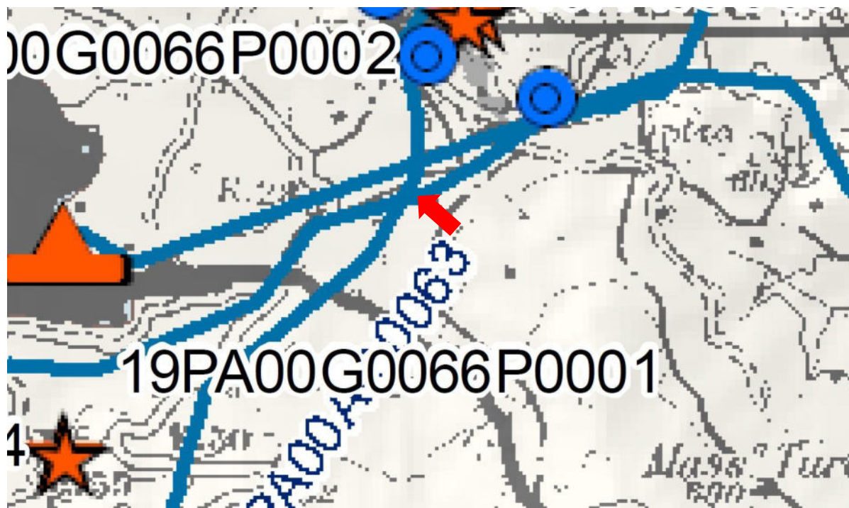
Figura 222. Planimetria attraversamento acquedotto interrato di ambito comunale (tratto da "Aggiornamento e Revisione del Piano Regolatore Generale degli Acquedotti" della Regione Siciliana.)
