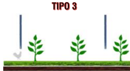
Figura 27. Sistema agrivoltaico in cui i moduli fotovoltaici sono disposti verticalmente. La coltivazione avviene tra le file dei moduli fotovoltaici, l'altezza minima dei moduli da terra influenza il possibile passaggio di animali
