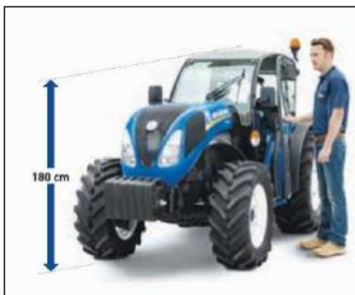
Figura 38. Dimensioni caratteristiche di un trattore da frutteto con cabina ribassata (Fonte: CNH)
