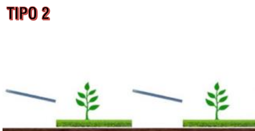
Figura 25. Sistema agrivoltaico in cui la coltivazione avviene tra le file dei moduli fotovoltaici, e non al di sotto di essi
