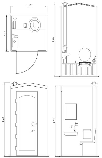
Bagno mobile chimico già assemblato e pronto all'uso in polietilene atermico ad alta densità antiurto e che consente alla cabina di essere calda in inverno e fresca in estate. La cabina è dotata: Wc chimico, orinatoio, erogatore di carta igienica, erogatore di disinfettante, contenitore disinfettante, sistema di aerazione della cabina, tetto traslucido, che filtra la luce dall'esterno.
