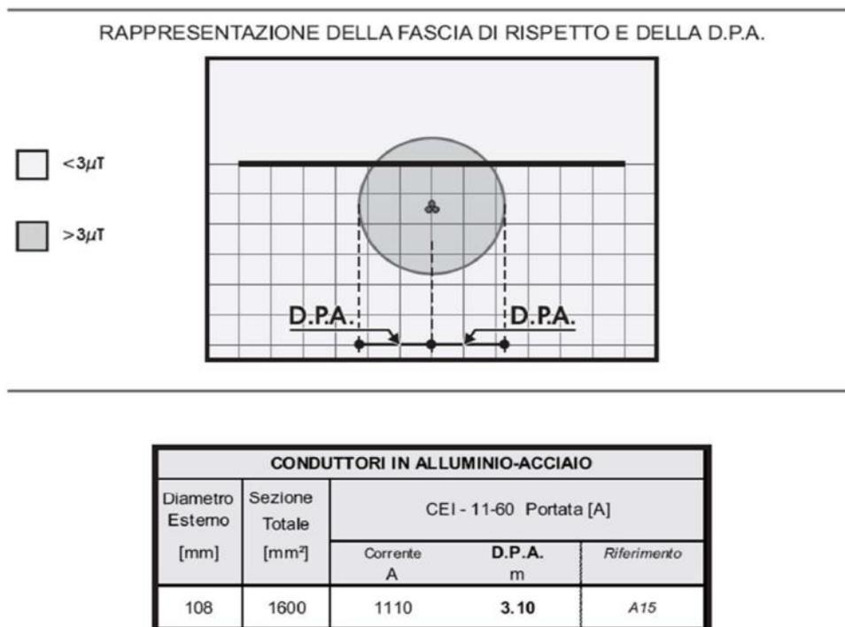
Figura 20: D.P.A per cavidotto interrato secondo norma CEI 11-60
