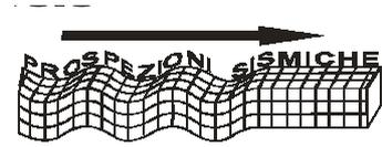
rente velocità di propagazione; in particolare, la velocità dello strato inferiore deve essere maggiore di quella dello strato superiore.
