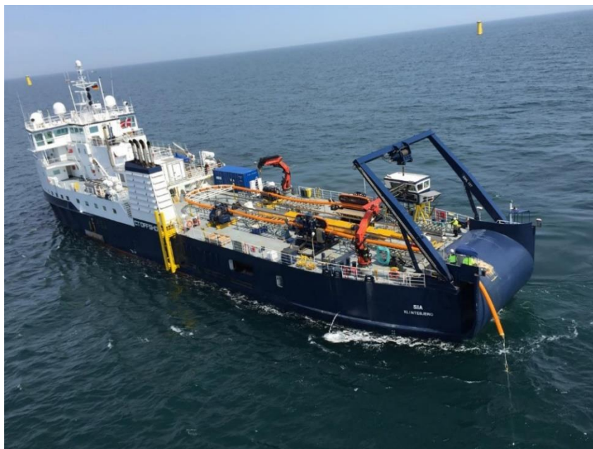
Figura 6-7 - Illustrazione dell'installazione del cavo (Fonte: Offshore Gode-wind)
