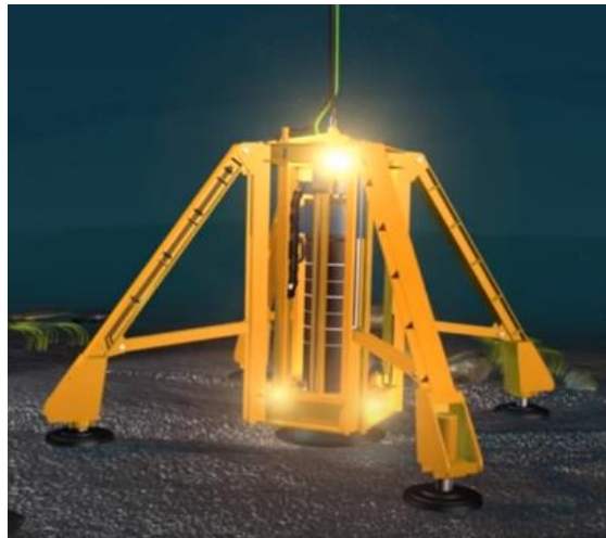
Figura 2.7 – Esempio di palo infisso nel fondale marino
