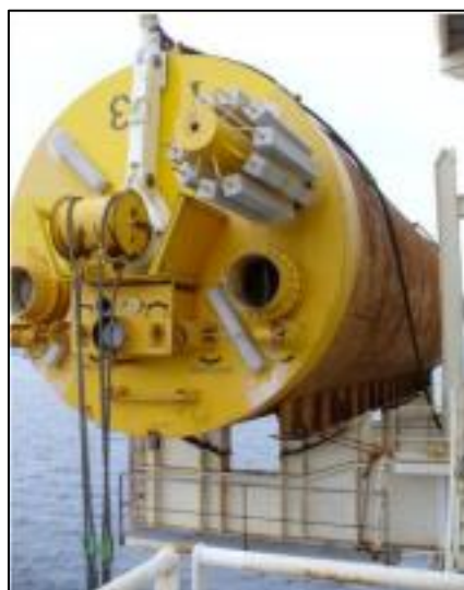
Figura 2.8 – Illustrazione di palo infisso per aspirazione
