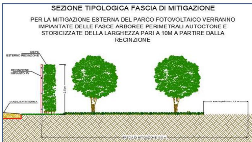
Figura 3 – sezione tipologica fascia di mitigazione perimetrale
