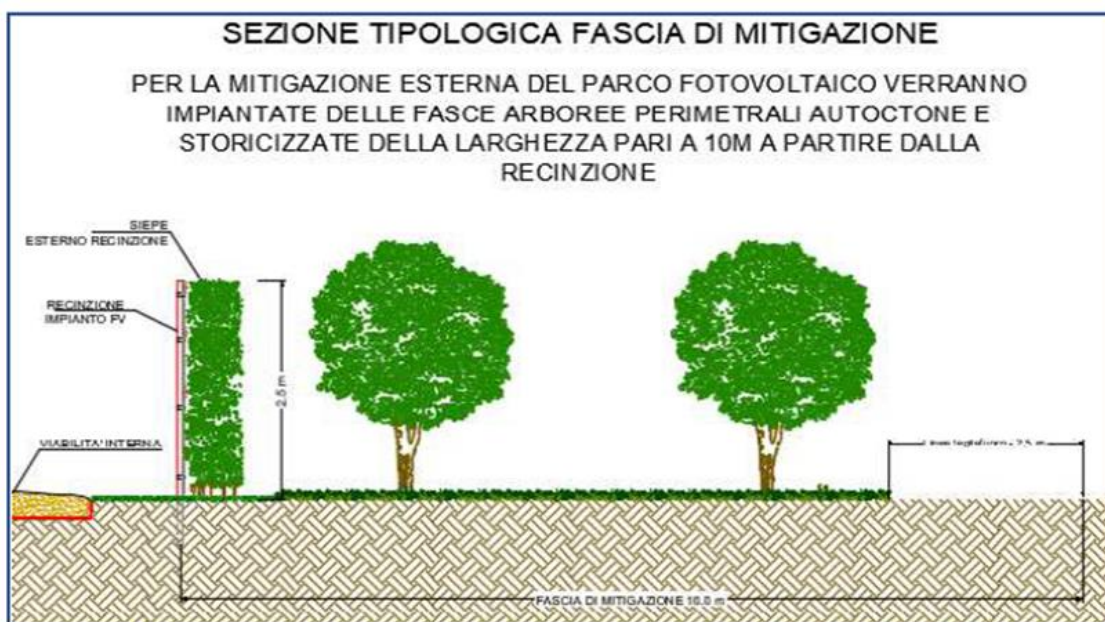
Figura III.6-Sezione tipologica fascia di mitigazione perimetrale
