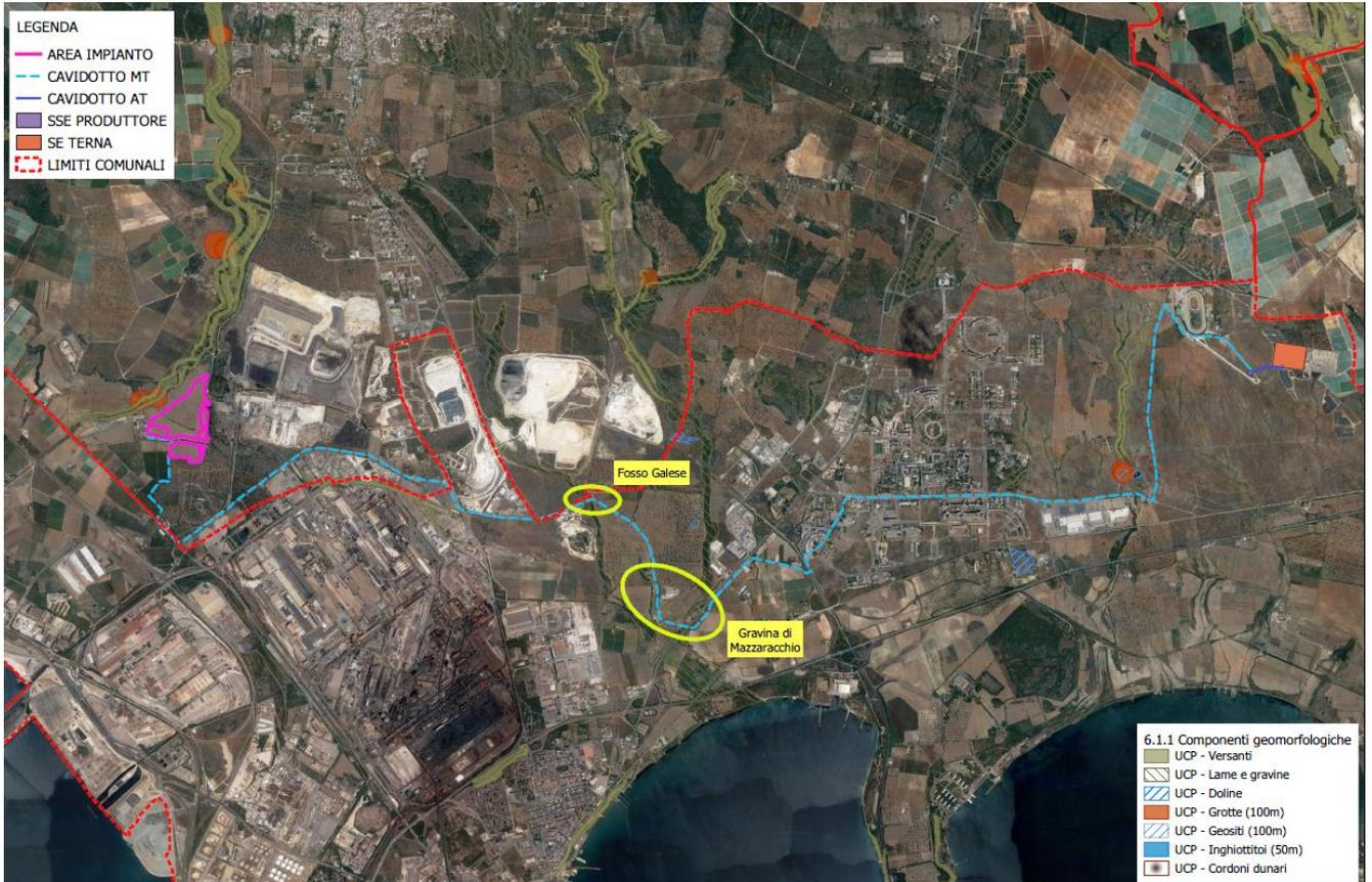
**Figura 4-14: PPTR – Componenti geomorfologiche: individuazione di BP e UCP lungo il cavidotto**
