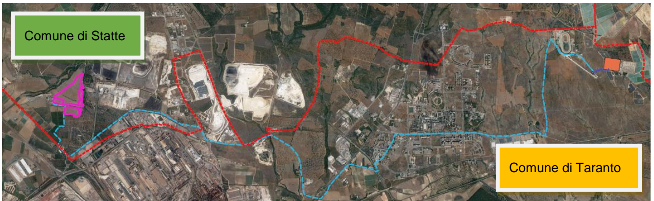
Figura 3-4: Inquadramento territoriale su Ortofoto del complesso del percorso del cavidotto di connessione MT (in azzurro)
