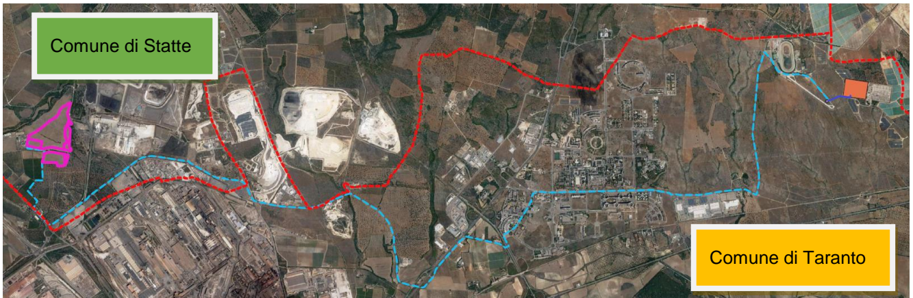
Figura 2-4: Inquadramento territoriale su Ortofoto del complesso del percorso del cavidotto di connessione MT (in giallo)
