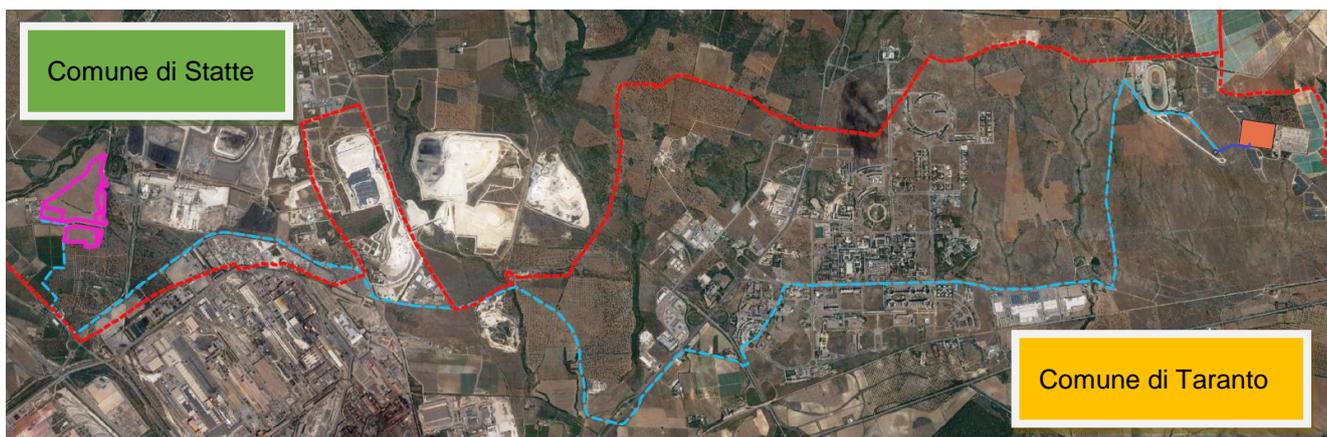
**Figura 1-3: Inquadramento territoriale su Ortofoto del complesso del percorso del cavidotto di connessione MT (in azzurro)**
