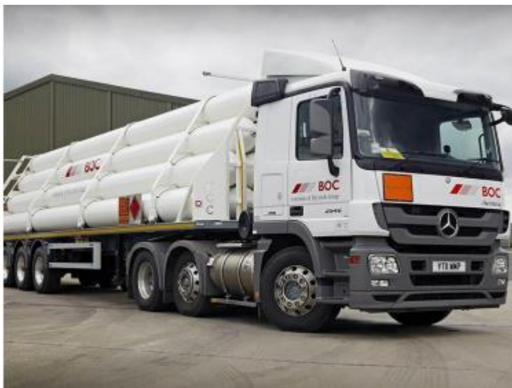
Figura 1: Esempio carro bombolaio (Categoria 5-LH) per trasporto H 2
