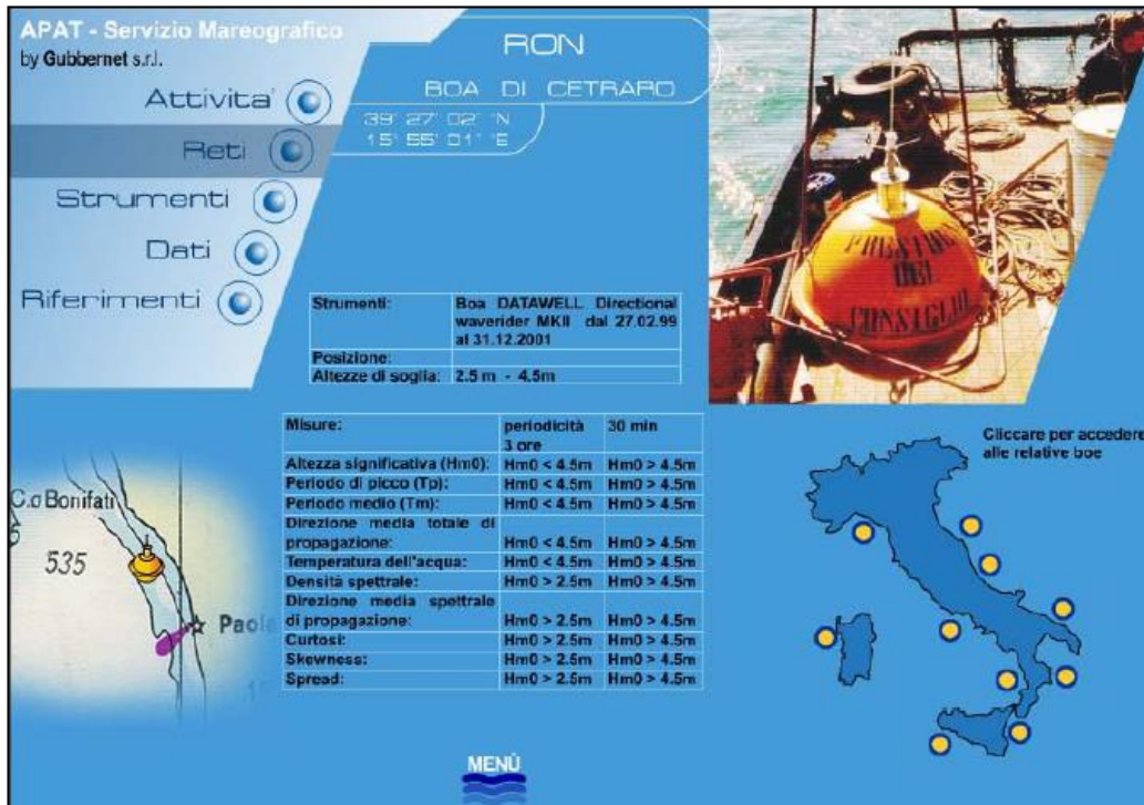
Figura 1.2 - Boa Datawell Directional Waverider (ondametro di Crotona)
