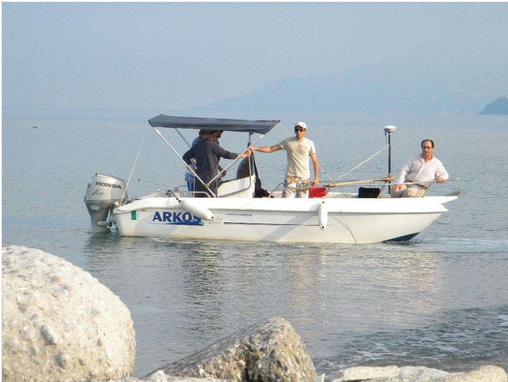
**Figura 2.1 - Ecoscandaglio con TCU e rover GPS montati sulla barca**
