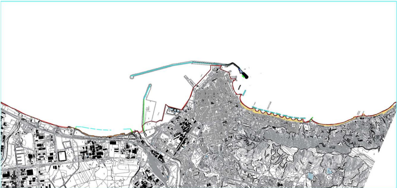
Figura 10: Dominio di calcolo di 8 km con presenza del prolungamento della diga foranea
