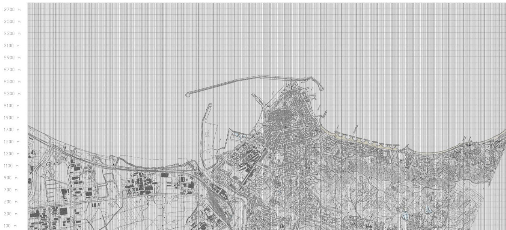
Figura 2: Griglia di calcolo del modello Gencade
