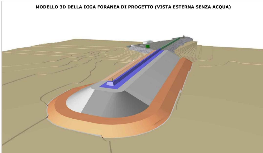
MODELLO 3D DELLA DIGA FORANEA DI PROGETTO (VISTA ESTERNA SENZA ACQUA)
