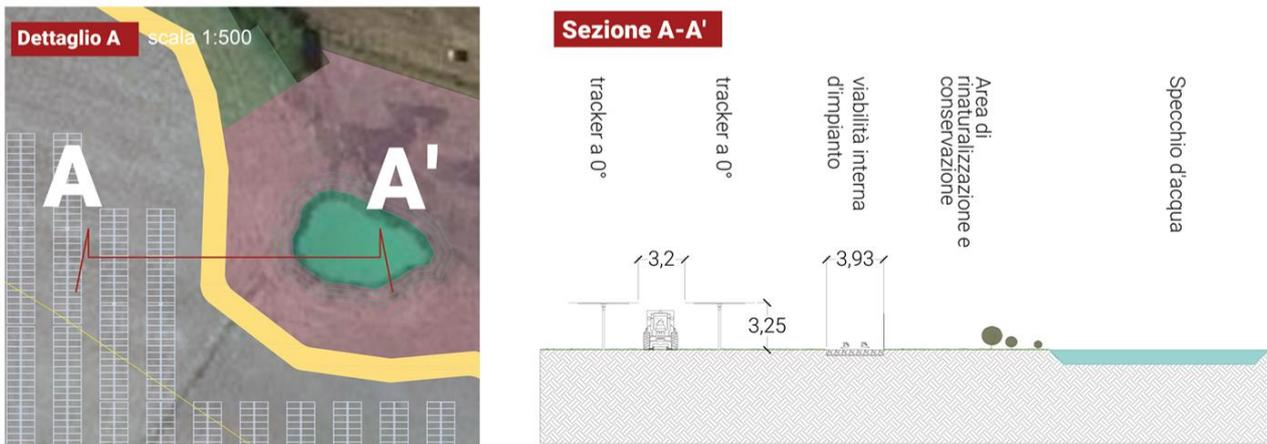
FIGURA 30 – PARTICOLARE FASCIA DI MITIGAZIONE DI NUOVO IMPIANTO E VIABILITÀ PERIMETRALE - SEZIONE O-E DELL'IMPIANTO (ESTRATTO DALL'ELABORATO GRAFICO PLOGAGHE-PDT11-R1) (IMMAGINE AGGIORNATA)
