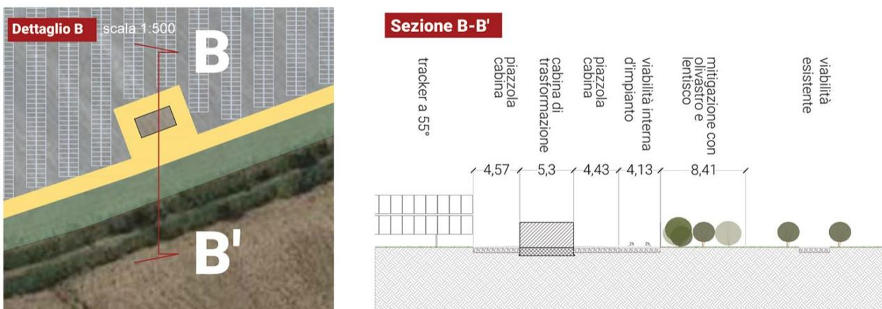
FIGURA 31 – PARTICOLARE FASCIA DI MITIGAZIONE CON VEGETAZIONE ESISTENTE E SEZIONE N-S DELL'IMPIANTO – ESTRATTO DALL'ELABORATO GRAFICO PLOAGHE-PDT11-R1) (IMMAGINE AGGIORNATA)
