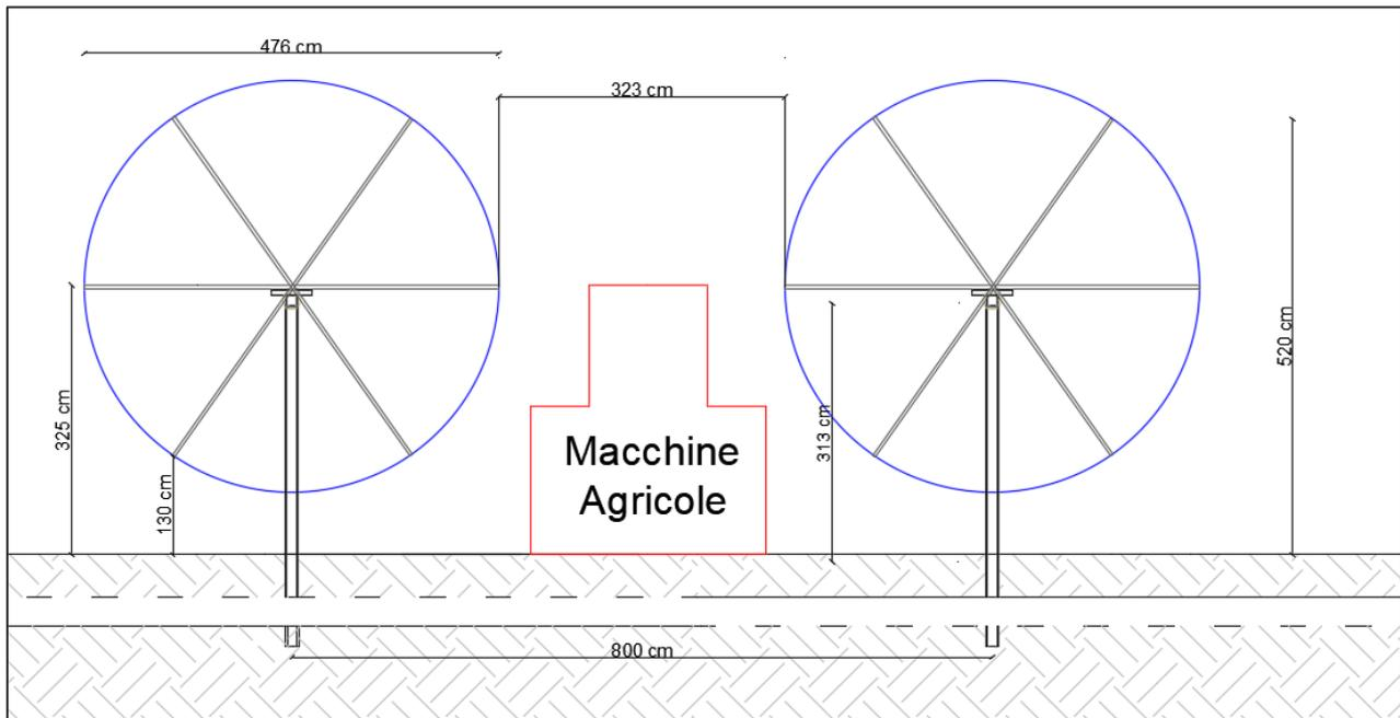
FIGURA 6: CONFIGURAZIONE STRUTTURE AD INSEGUIMENTO IMPIANTO AGRIVOLTAICO
