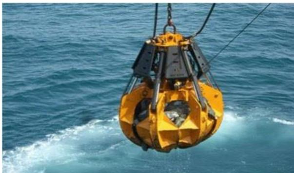
Figura 2.10 – Benna in azione con l’ausilio di gru, utilizzata per il sollevamento di oggetti presenti sul fondale.
