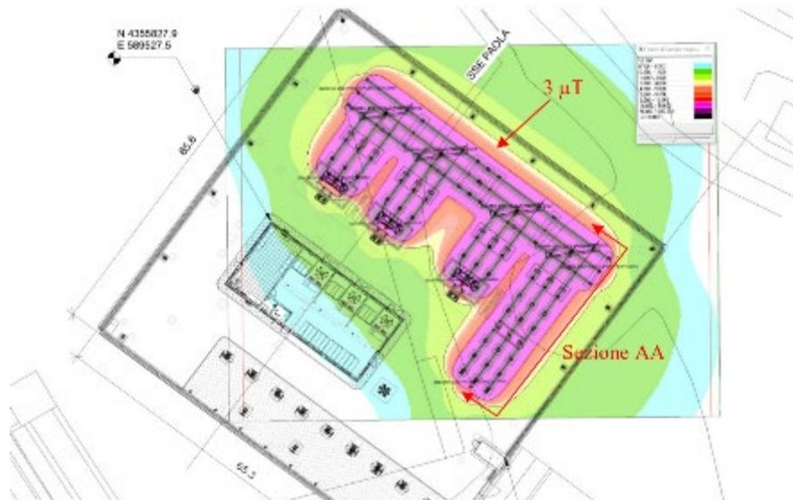
Figura 16: Valori di campo magnetico relativi al sistema di sbarre AT della SSE di Paola (vista in pianta).
