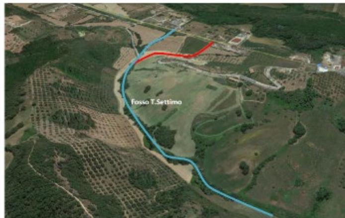
Figura 15: Deviazione del fosso torrente Settimo in progetto (linea rossa).
