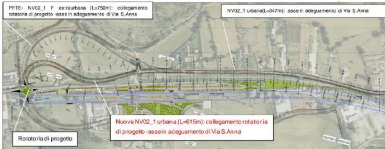
Figura 7: Configurazione della nuova viabilità in adiacenza alla stazione ferroviaria.
