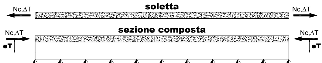
Figura 2.3 - Azioni statiche equivalenti alla variazione termica negativa
