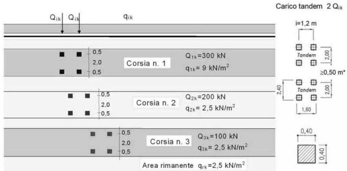
Figura 16 Schema di carico 1
