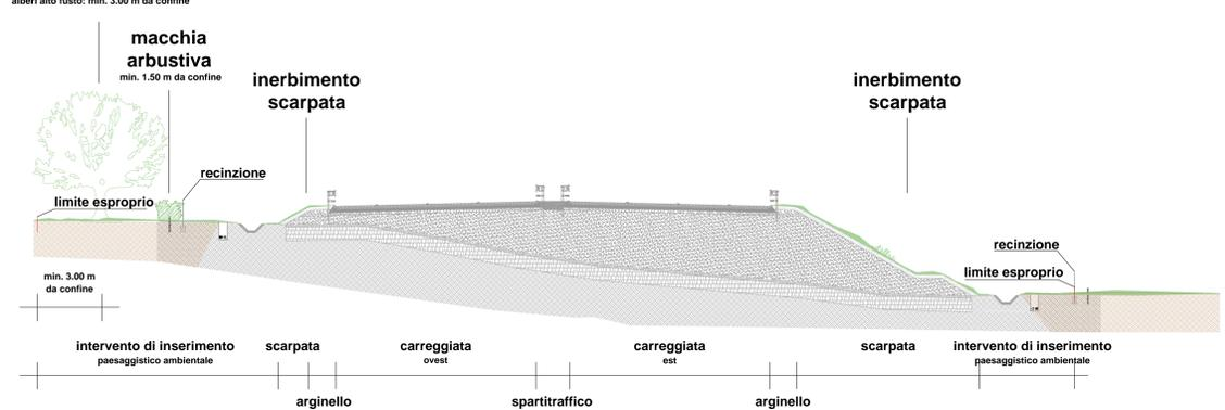
Sezione tipo in rilevato - Strade locali
