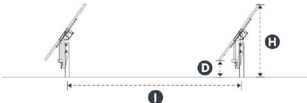
Figura 4 - Vista laterale della struttura portamoduli tracker
