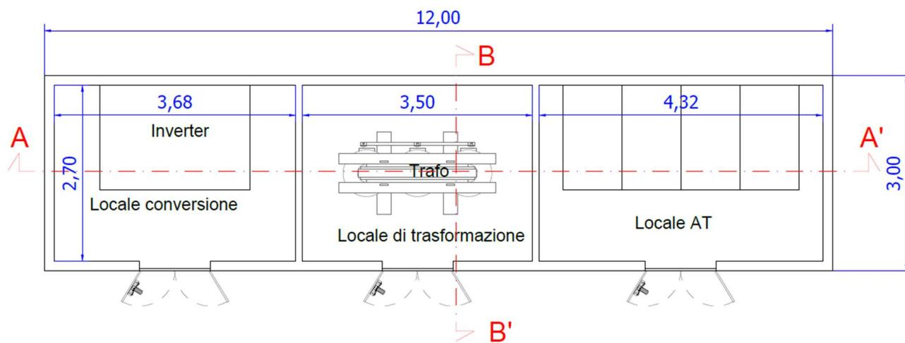
Figura 9 – Cabina elettrica PS prefabbricata in c.a.v. - Pianta
