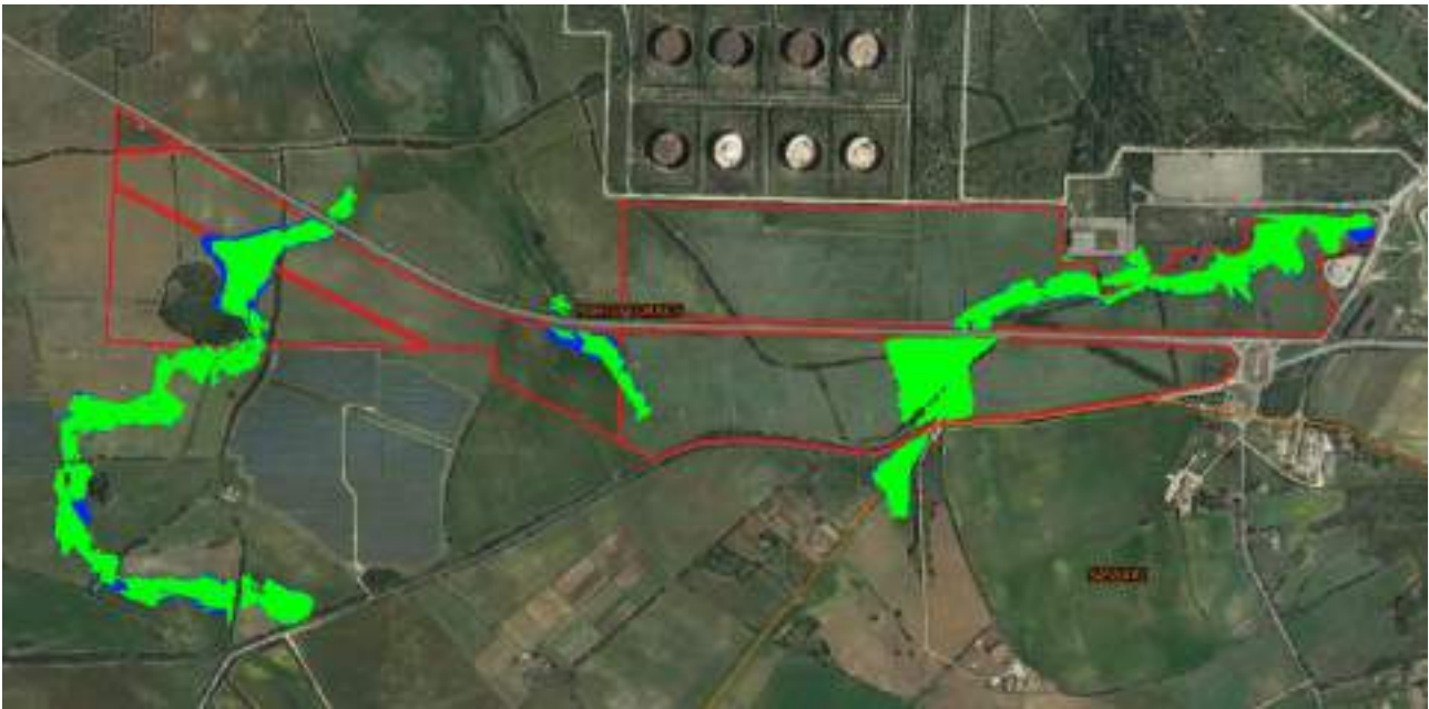
Sovrapposizione perimetrazioni aree inondabili - T = 100 anni – Ante Operam (verde) – Post Operam (blu).
