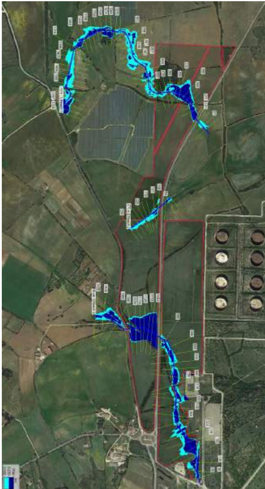
Planimetria tiranti – T = 100 anni – Ante Operam – azzurro h < 0.25 m – blu h > 0.25 m
