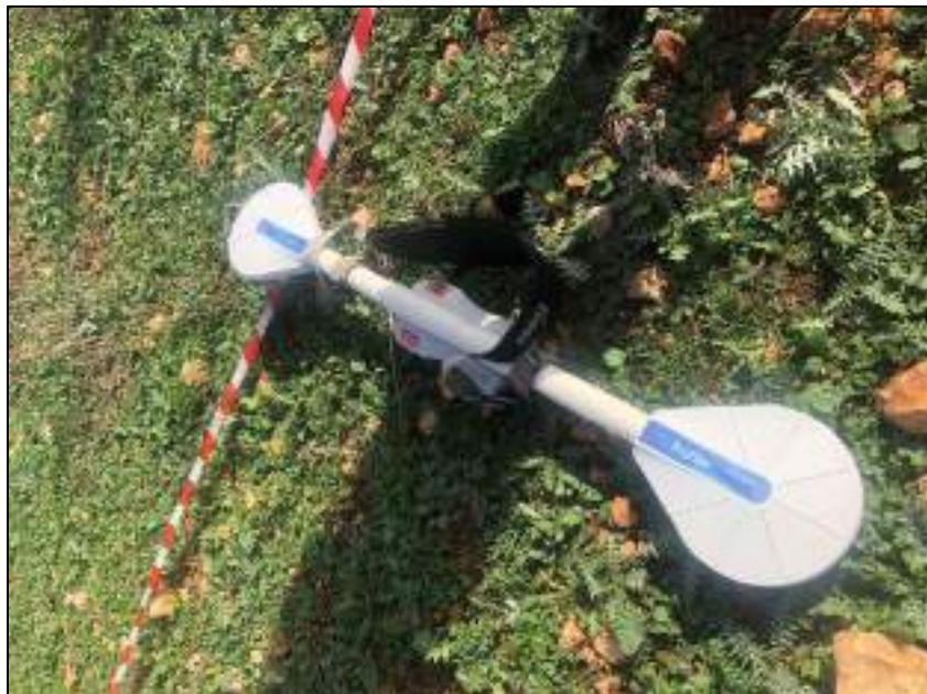
Figura 21: strumento utilizzato per acquisizione indagine FDEM
