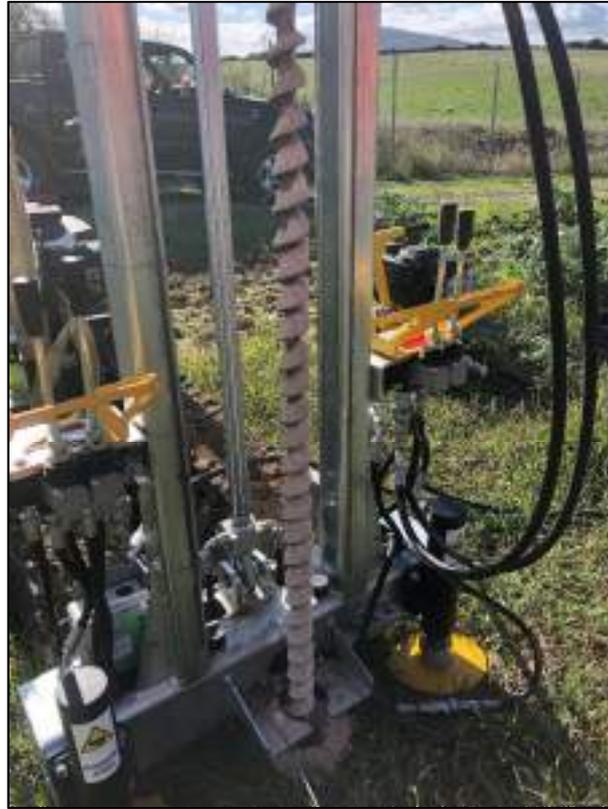
Figura 16: Esecuzione borehole
