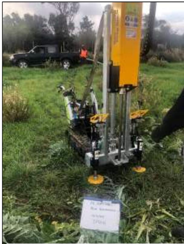
Figura 17: esecuzione prove penetrometriche DPSH
