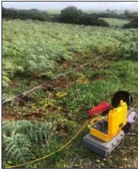
Figura 19: esecuzione indagini sismiche MASW
