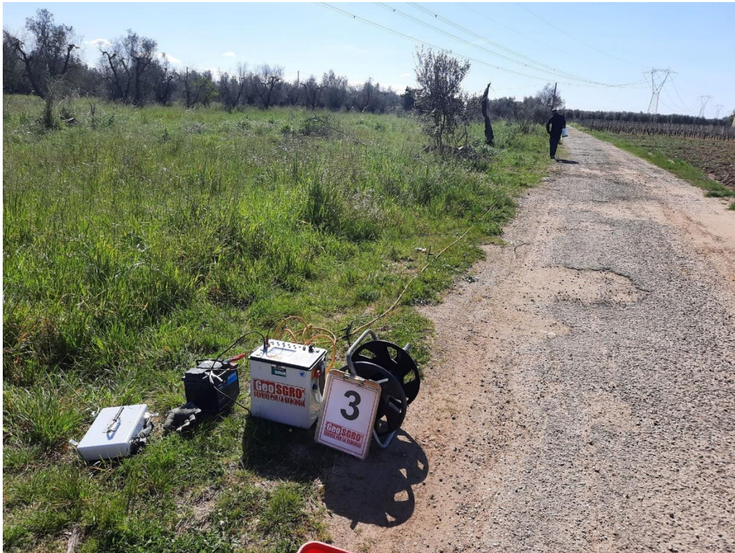
Vista ubicazione array geoelettrico ERT 3
