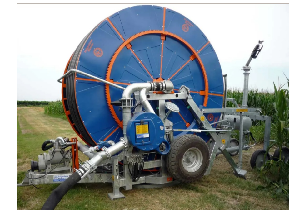
Irrigazione ad aspersione sul prato polifita che consente la bagnatura dei pannelli fotovoltaici
