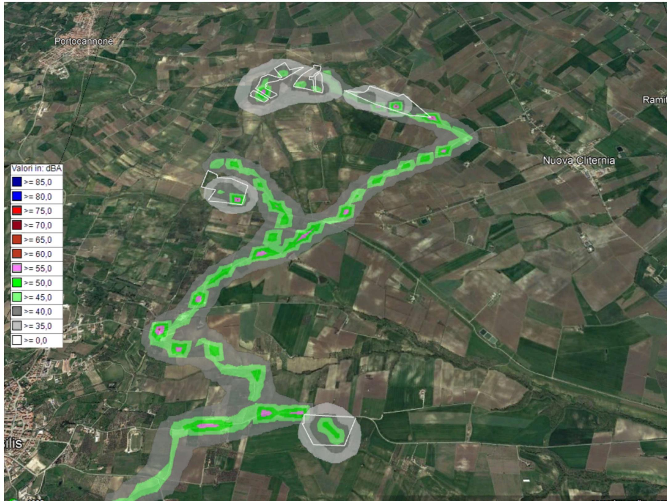
Risultato dello studio modellistico in fase di cantiere e scavo tracciato
