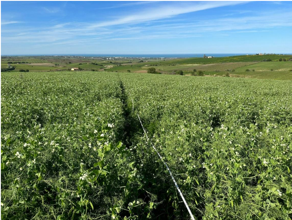
Esecuzione profilo sismico a rifrazione 2-2' e Masw n.2 sullo stesso stendimento
