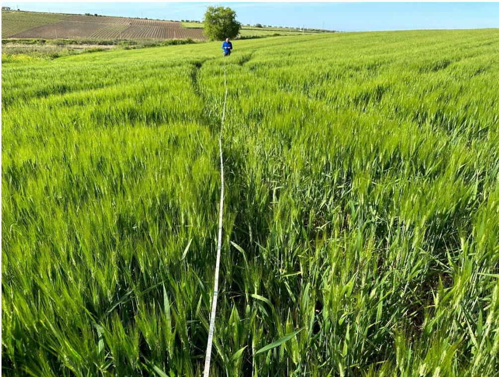
Esecuzione profilo sismico a rifrazione 4-4'
