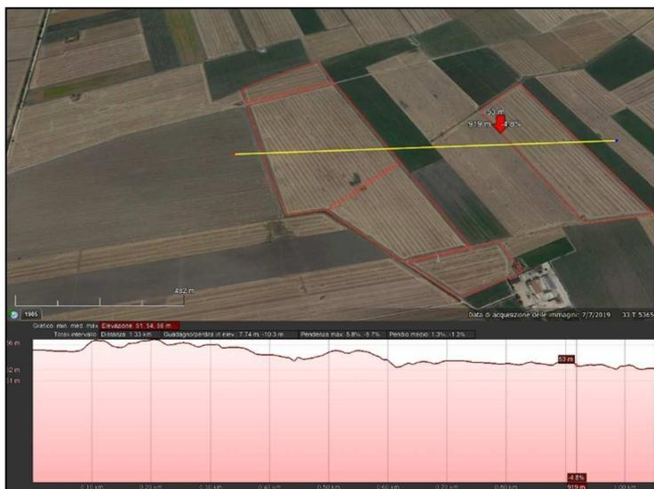
Figure 2: Sezione 1 orografia del terreno.
